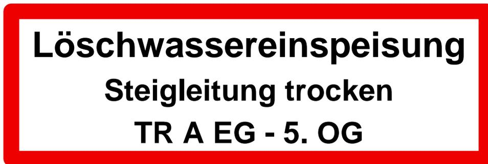
Abbildung 4: Beispiel-Hinweisschild zur Kennzeichnung einer Einspeiseeinrichtung für eine Steigleitung trocken mit dem Versorgungsbereich Treppenraum „A“ 1. Ober- bis 5. Obergeschoss.
