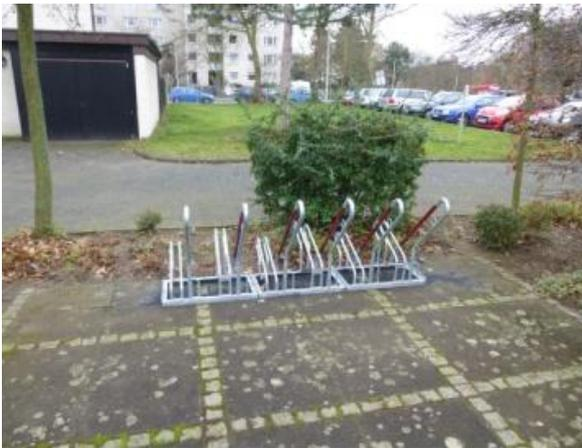
**Abb. 63: Vorderradhalter mit Rahmenanschlussmöglichkeit**
