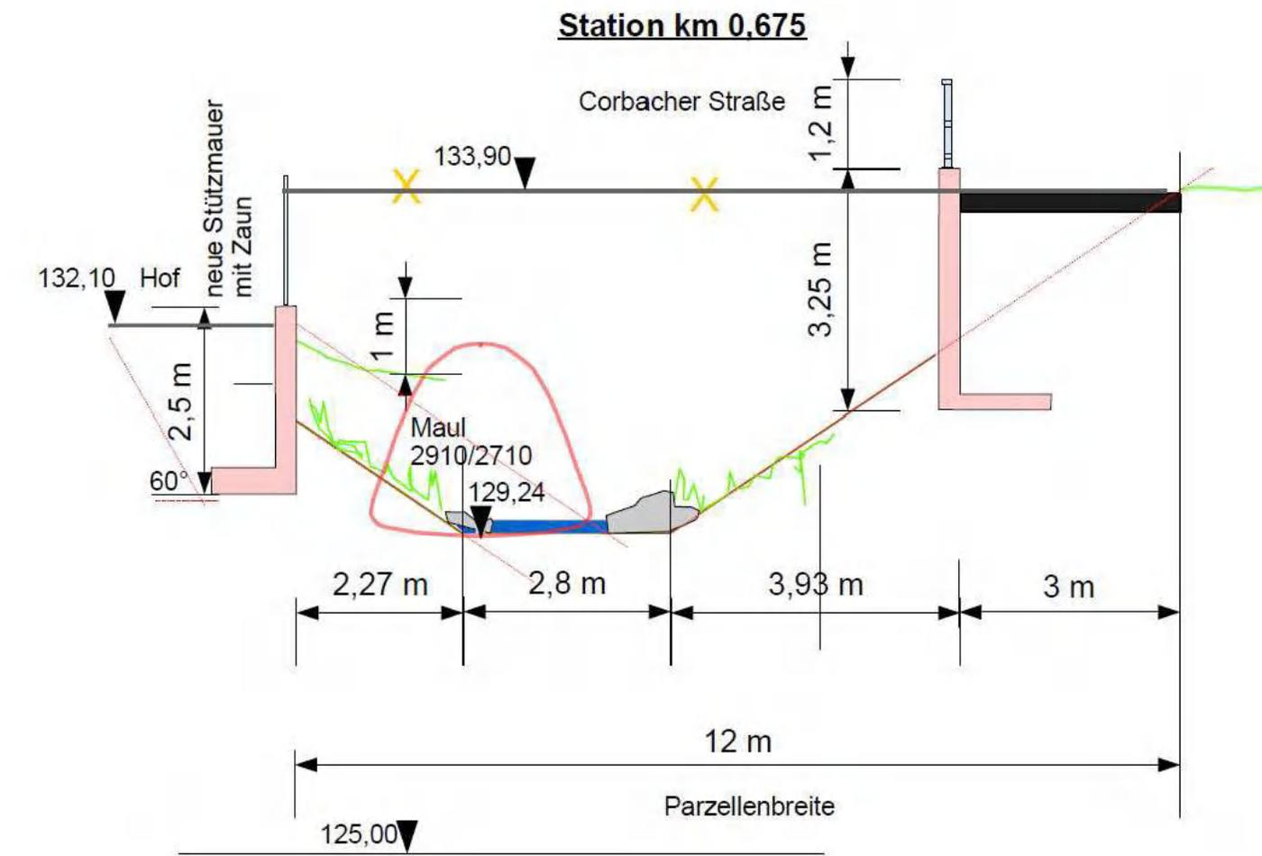
Insgesamt ca. 4.000 m<sup>3</sup> Bodenaushub für Offenlegung
