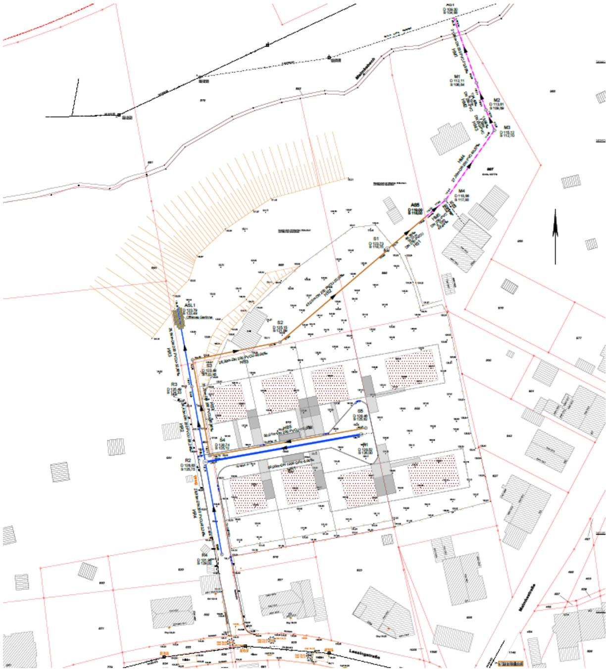
Abbildung 8: Geplante Schmutzwasserentwässerung
