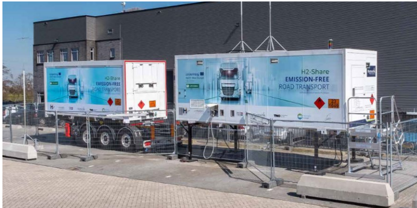
Abbildung 3-11: Beispiel für eine mobile Wasserstofftankstelle, Quelle: Wystrach
