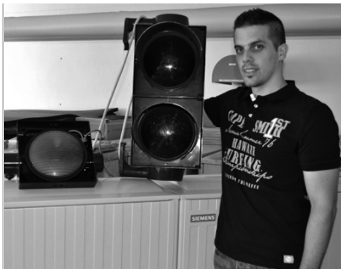
Markus Falkenroth, Fachbereichsleiter Verkehrstechnik/WBH, mit einer alten Ampel, die mit LED-Einheiten aufgerüstet wird
